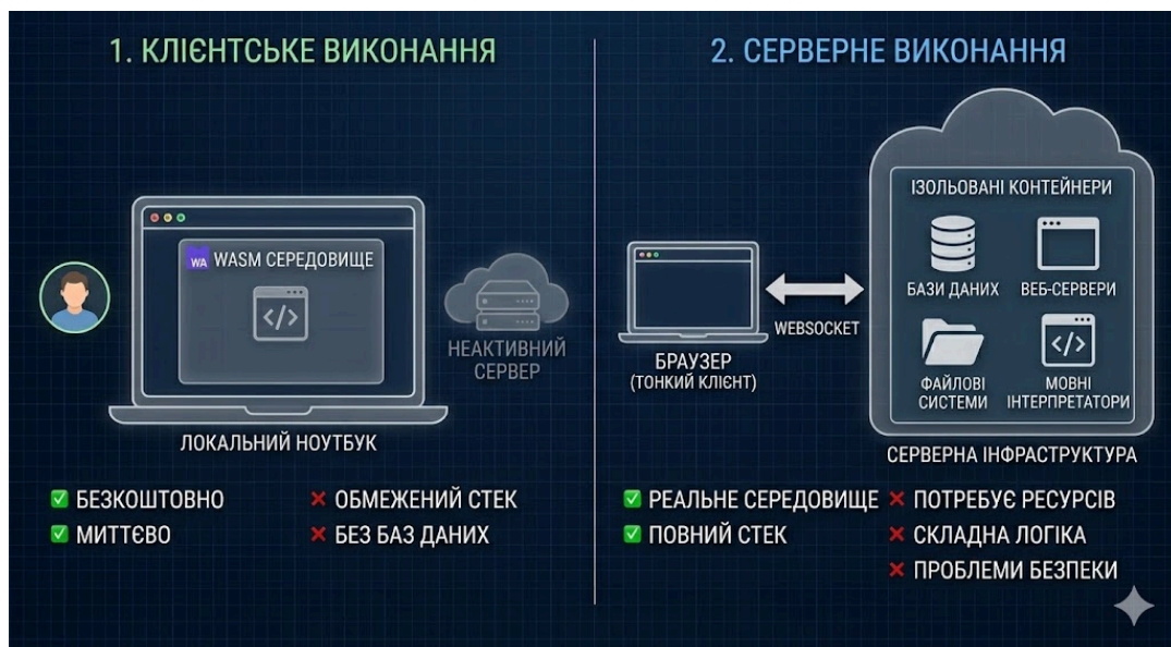
Рис. 1.5 – Порівняльна схема архітектур клієнтського та серверного виконання коду
